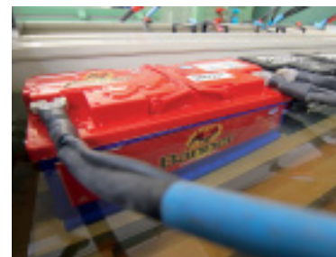
Bei konstant 25 Grad durchlaufen die Batterien im Wasserbad einen Großteil des Tests.
